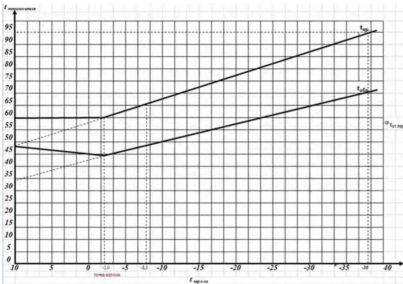
Рисунок 12 - Температурный график регулирования отпуска тепловой энергии Центральной котельной
