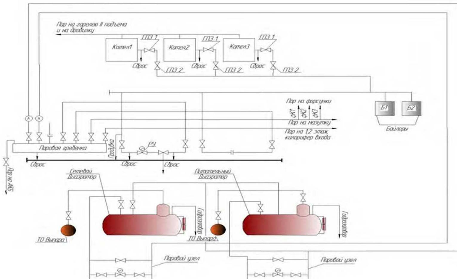
Рисунок 1 - Тепловая схема парового тракта (контура) Центральной котельной (паровая очередь)
