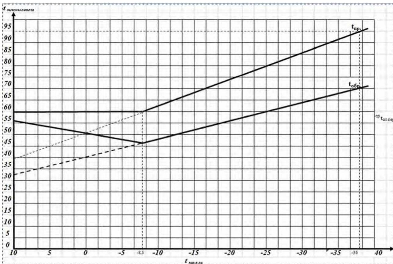
Рисунок 13 - Температурный график регулирования отпуска тепловой энергии котельной микмкр. Березовый
