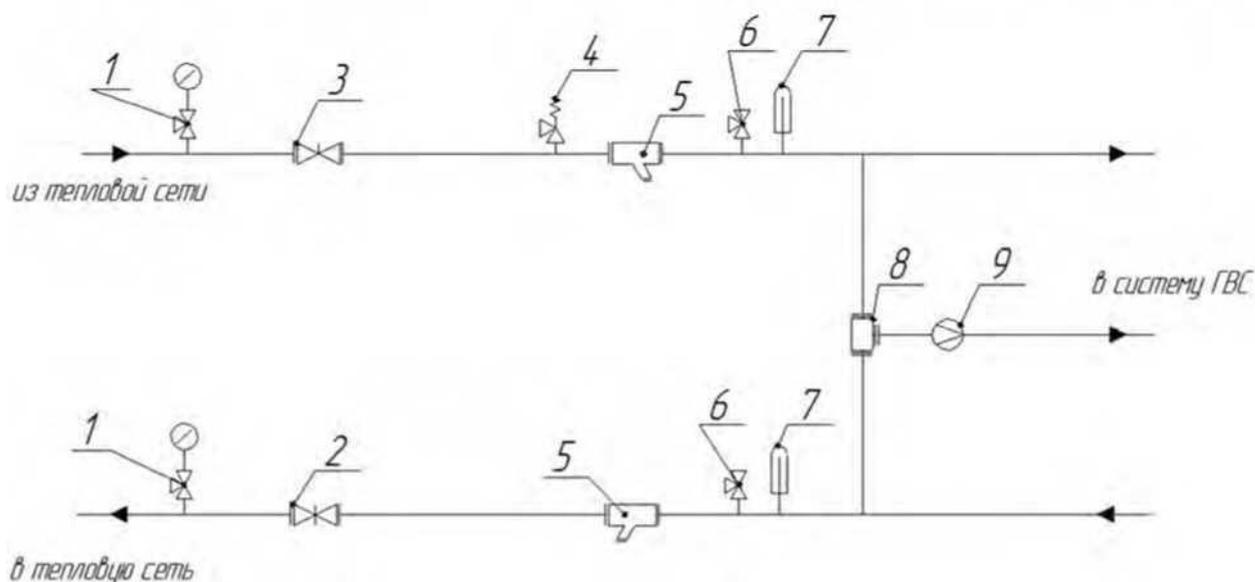
Рисунок 14 – Схема ИТП для частных жилых зданий г. Свирска
