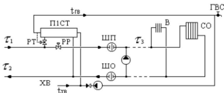
Рисунок 20– Схема теплового пункта с параллельным подключением подогревателей ГВС и насосным присоединением СО и СВ
