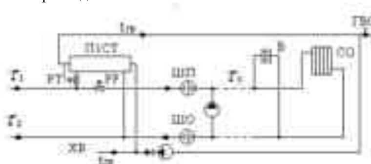
Рисунок 2– Схема теплового пункта с параллельным подключением подогревателей ГВС и насосным присоединением СО и СВ
