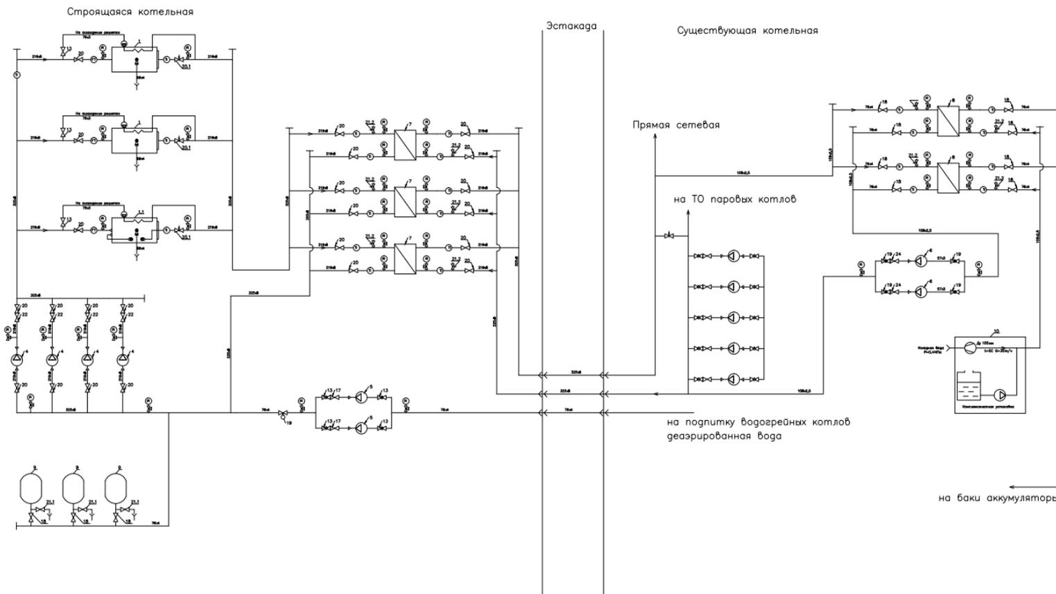
Рисунок 2 - Тепловая схема водогрейной очереди Центральной котельной
