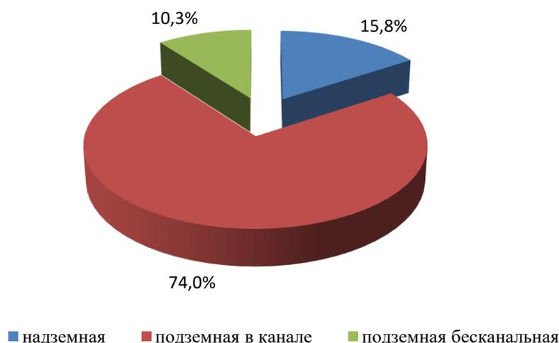
Рисунок 10 – Протяженность тепловых сетей г. Свирска с распределением по типам прокладки
