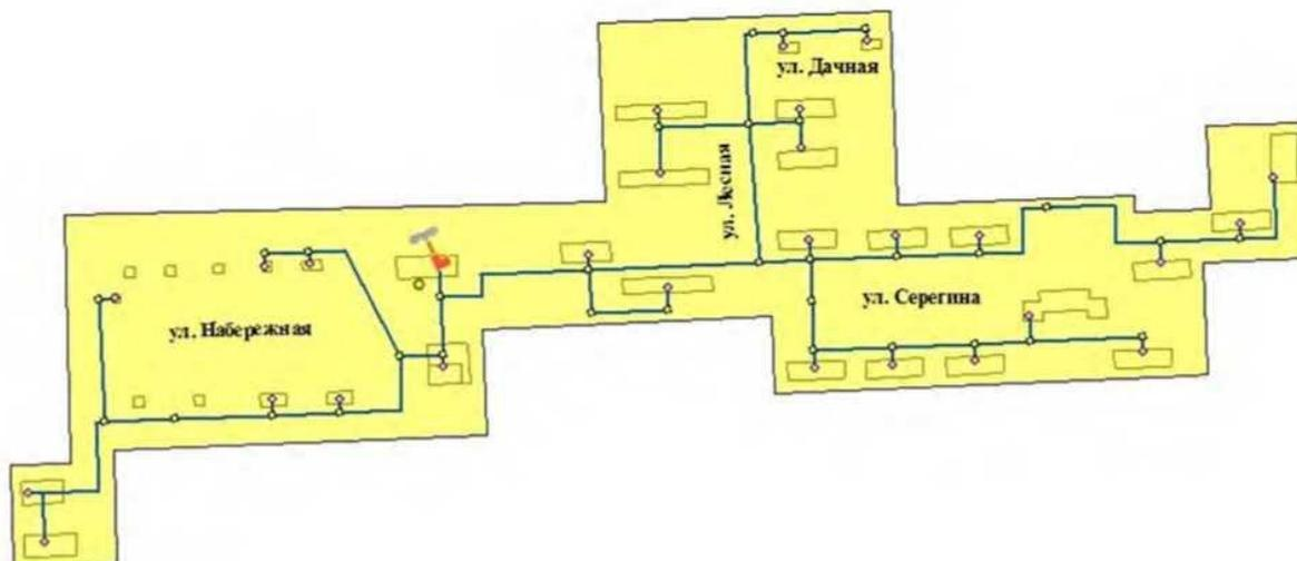
Рисунок 8- Схема тепловой сети от Котельная мкр. Березовый
