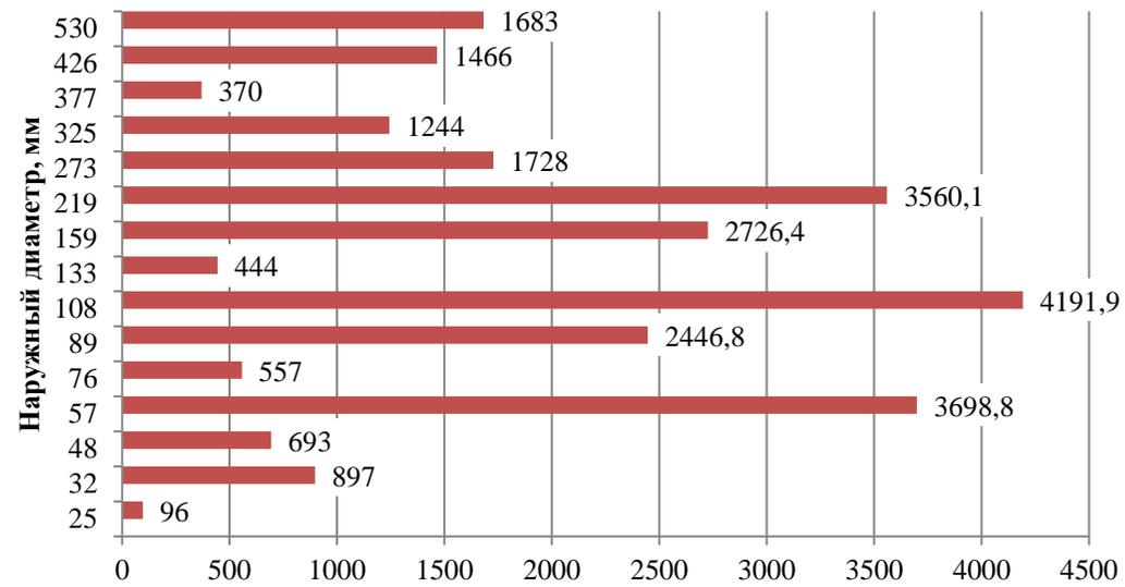
Рисунок 11 - Протяженность тепловых сетей с распределением по диаметрам трубопроводов (в двухтрубном исчислении)
