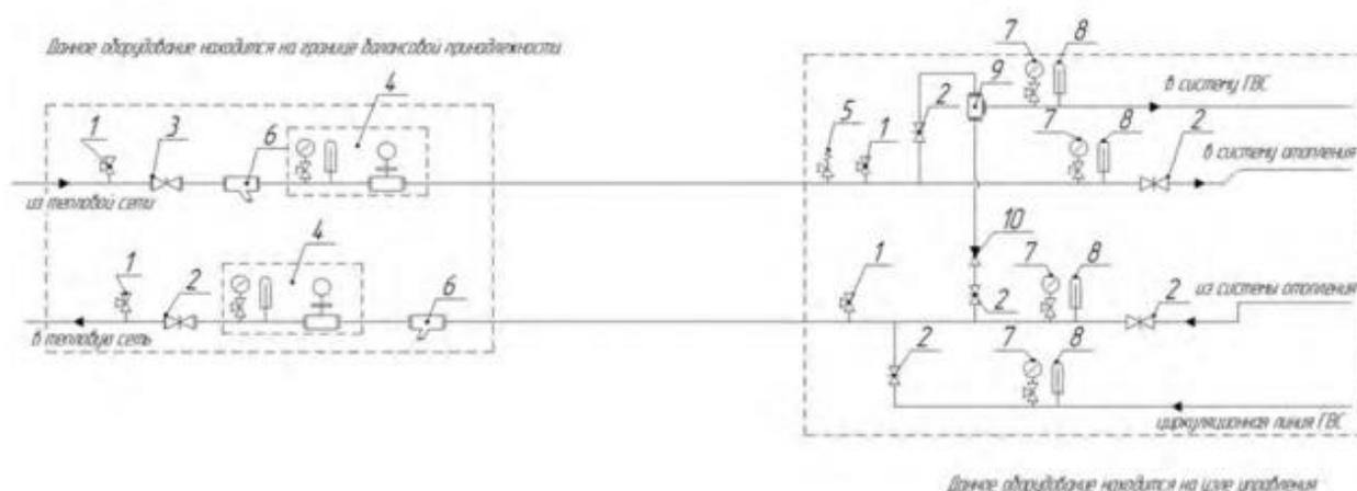
Рисунок 15 – Схема ИТП для МКД г. Свирска
