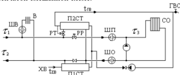
Рисунок 21 – Схема теплового пункта с двухступенчатым смешанным подключением подогревателей ГВС и насосным присоединением СО
