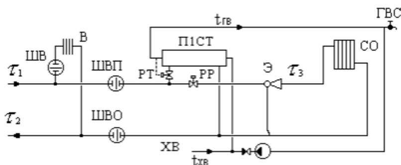
Рисунок 19– Схема теплового пункта с параллельным подключением подогревателей ГВС и элеваторным присоединением СО
